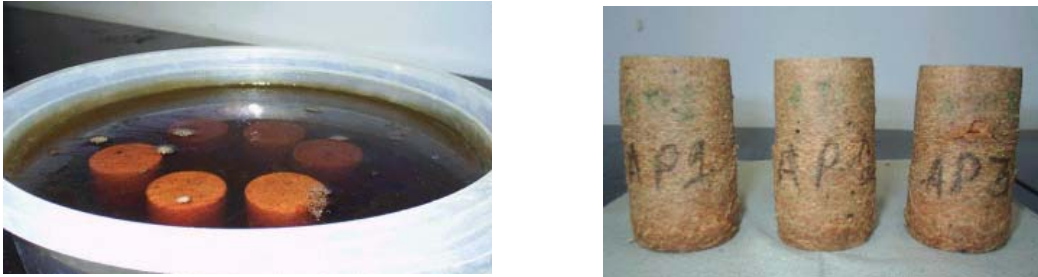
Figura 6: C.p.s submersos (detalhe: película de óleo na superfície da água) e após ensaio.
