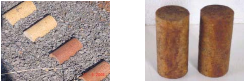
Figura 7: C.p.s no campo e c.p.s de Pinus 2 meses após exposição no tempo.
